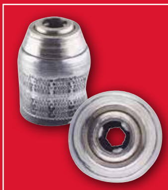
Ødelagt borepatron pga. forkert brug
