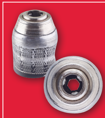
Boorhouder defect door onoordeelkundig gebruik
