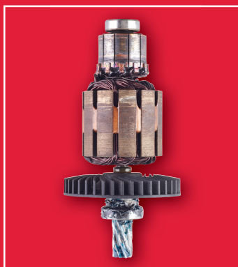
Doorgebrande motor wegens overbelasting.
