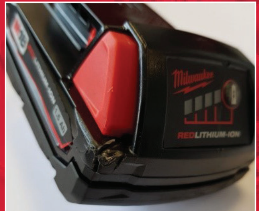
Voorbeeld van val- of stootschade van een MILWAUKEE® accu.
