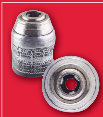
Boorhouder defect door onoordeelkundig gebruik
