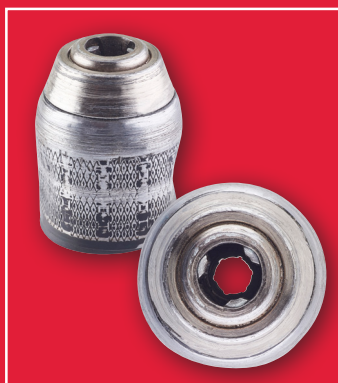
Boorhouder defect door onoordeelkundig gebruik
