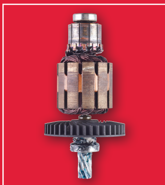
Doorgebrande motor wegens overbelasting.
