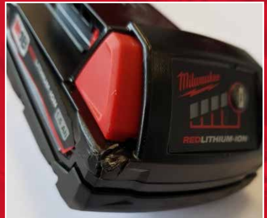
Esimerkki MILWAUKEE®-akkuun kohdistuneesta suuresta pudotuksesta tai iskusta
