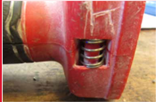
Jousi asennettu ulkopuolelle, mikä osoittaa työkalun valtuuttamattoman avaamisen
