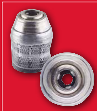
Väärinkäytön vuoksi rikkoutunut istukka
