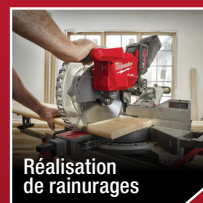
Réalisation de coupes d'onglets
