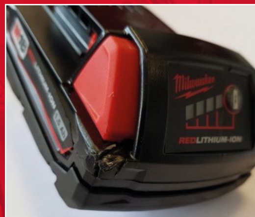
Exemple de chute ou d'impact d'une batterie MILWAUKEE®
