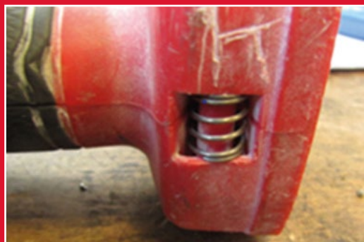
Ressort assemblé à l'extérieur, prouvant l'ouverture non autorisée de l'outil
