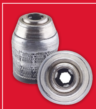
Mandrin cassé suite à une mauvaise utilisation
