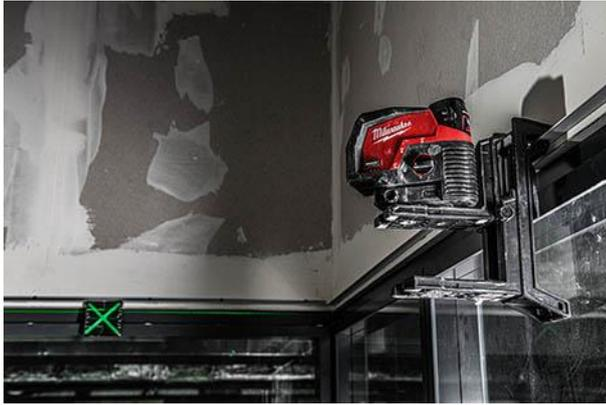
*Eine Laserzieltafel mit Magnetboden und kontrastreicher, reflektierender Oberfläche und X-förmigen Markierungen erleichtern und beschleunigen den Aufbau erheblich.*
