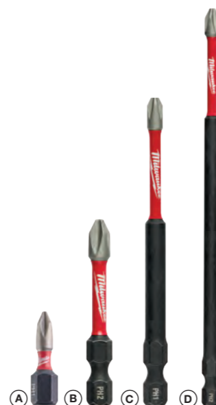
A) 25 mm 1/4" Hex - DIN 3126 - C 6.3 B) 50 mm 1/4" Hex - DIN 3126 - E 6.3 C) 90 mm 1/4" Hex - DIN 3126 - E 6.3 D) 150 mm 1/4" Hex - DIN 3126 - E 6.3
