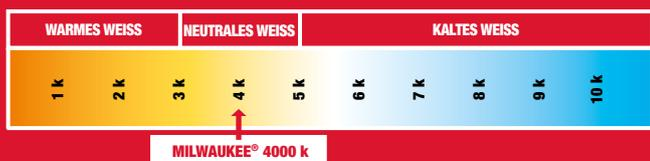
Höhere Farbtemperaturwerte in Kelvin (über 5.000 K) sind kühler und zeigen ein bläuliches Licht. Niedrigere Farbtemperaturen (2.700 - 3.000 K) sind wärmere oder rötliche Farben. Eine neutralweiße Farbe verbessert die Arbeitsproduktivität und -sicherheit und ist weniger anstrengend für die Augen.
