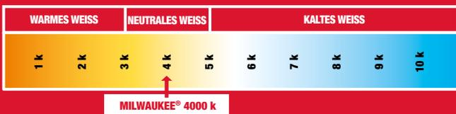
Höhere Farbtemperaturwerte in Kelvin (über 5.000 K) sind kühler und zeigen ein bläuliches Licht. Niedrigere Farbtemperaturen (2.700 - 3.000 K) sind wärmere oder rötliche Farben. Eine neutralweisse Farbe verbessert die Arbeitsproduktivität und -sicherheit und ist weniger anstrengend für die Augen.
