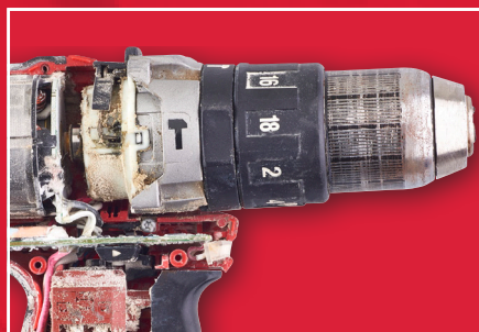
Beispiel für übermäßigen Verschleiß
