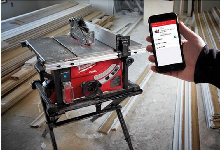
*Die Akku-Tischkreissäge FUEL M18 FTS210 kann mit dem vollen Funktionsumfang des cloudbasierten ONE-KEY-Systems verwendet werden.*
