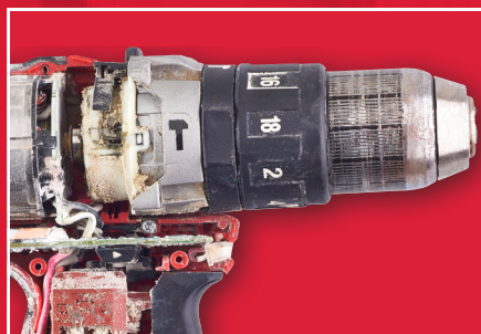
Beispiel für übermäßigen Verschleiß
