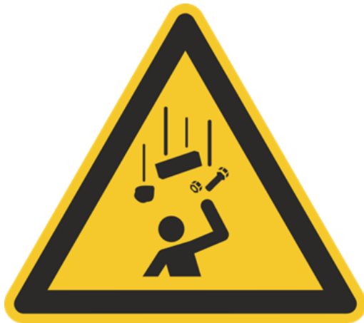
Warnzeichen W035 nach EN ISO 7010: Warnung vor herabfallenden Gegenständen
