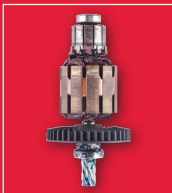
Motore bruciato a causa di sovraccarico
