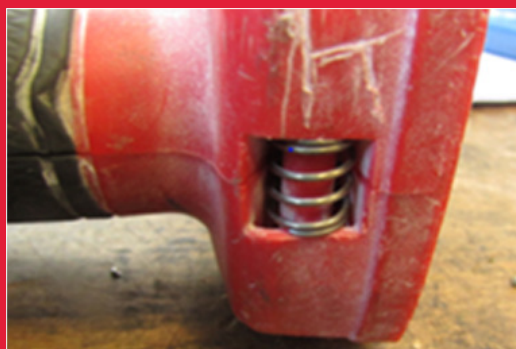
Molla assemblata esternamente, che dimostra l'apertura non autorizzata dell'utensile
