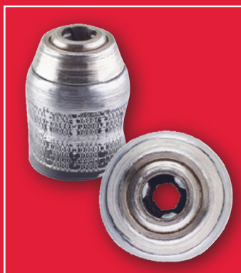
Mandrino rotto a causa di uso improprio
