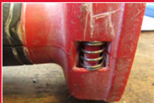
Fjeder monteret udvendigt. Tegn på uautoriseret åbning af værktøjet
