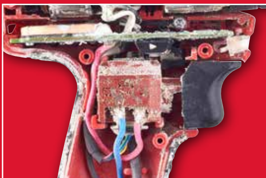
Kontakten kunne ikke aktiveres pga. snavs i værktøjet
