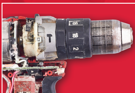
Esempio di eccessiva usura
