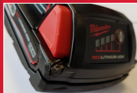
Príklad vonkajšej sily (silný náraz)
