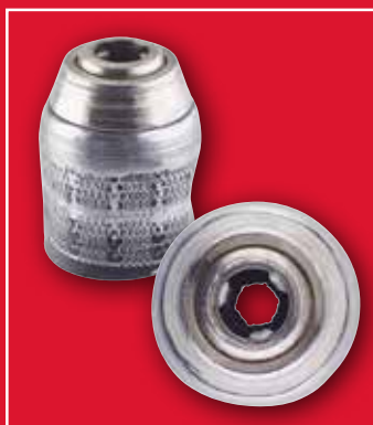
Ødelagt chuck som skyldes feil bruk
