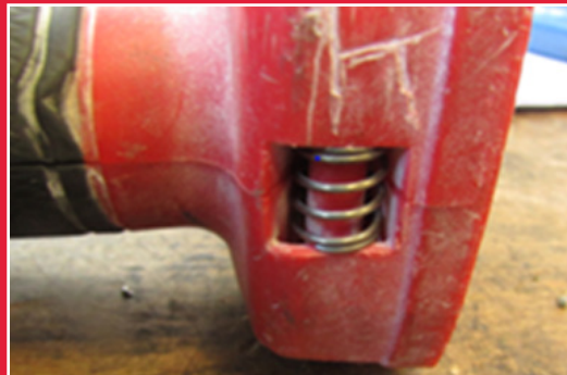
Mola montada externamente, prova de que a máquina foi aberta sem autorização
