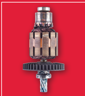
Motor ars din cauza supraîncărcării
