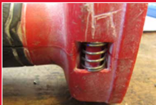
Utvändigt monterad fjäder – bevis på icke auktoriserad öppning av verktyget
