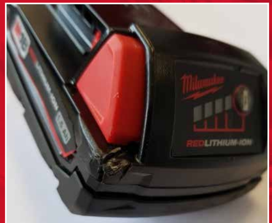
Exempel på skadat MILWAUKEE® batteri som tappats eller fått ett kraftigt slag
