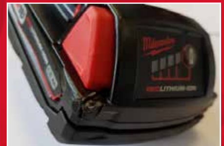
Exempel på yttre påverkan (kraftigt slag)
