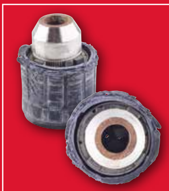
Ødelagt på grunn av kraftig påvirkning
