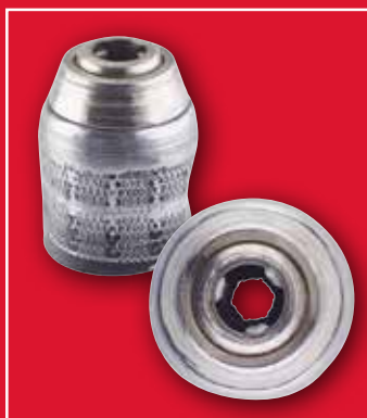
Ødelagt chuck som skyldes feil bruk
