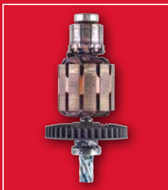
Brent motor på grunn av overbelastning
