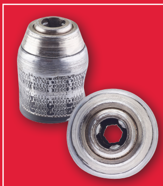
Uchwyt uszkodzony z powodu niewłaściwego użytkowania
