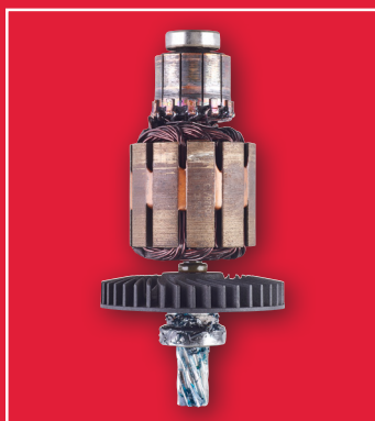
Silnik spalony z powodu przeciążenia
