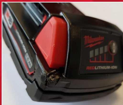
Przykład akumulatora MILWAUKEE®, który uległ poważnemu upadkowi lub uderzeniu
