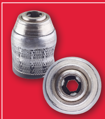
Uchwyt uszkodzony z powodu niewłaściwego użytkowania
