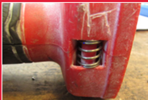
Sprężyna zamontowana na zewnątrz, co stanowi dowód na fakt nieuprawnionego otwarcia narzędzia.
