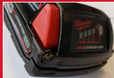
Przykład działania siły zewnętrznej (silne uderzenie)
