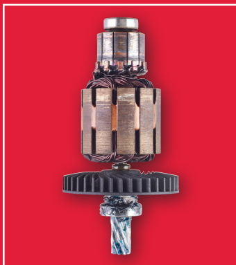
Spálený motor v dôsledku preťaženia
