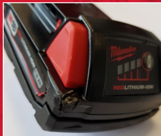
Príklad extrémneho pádu alebo nárazu do batérie MILWAUKEE®
