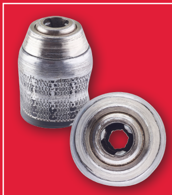
Zlomené skľučovadlo v dôsledku nesprávneho použitia
