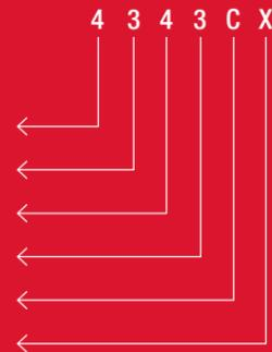
La norma EN 388 especifica requisitos, métodos de prueba, marcado e información que deben proporcionarse para los guantes de protección contra los riesgos mecánicos de abrasión, corte de cuchilla, desgarrar, perforación y, en su caso, impacto.
