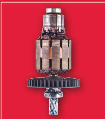
Verbrannter Motor aufgrund von Überlastung
