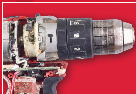
Beispiel für übermäßigen Verschleiß
